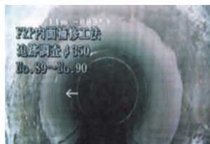
4. φ350 (HP) 補修箇所(クラック B、浸入水 B)、熱硬化
