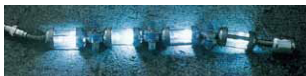
UVトレイン (TVカメラ、温度センサー付)
