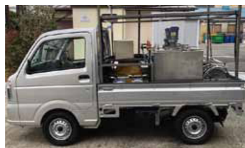
R止水工事車両 (軽トラック搭載)
