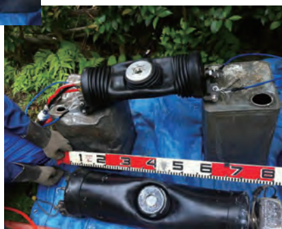
通常の一体型施工機(200-150)との比較 全長…85cm
